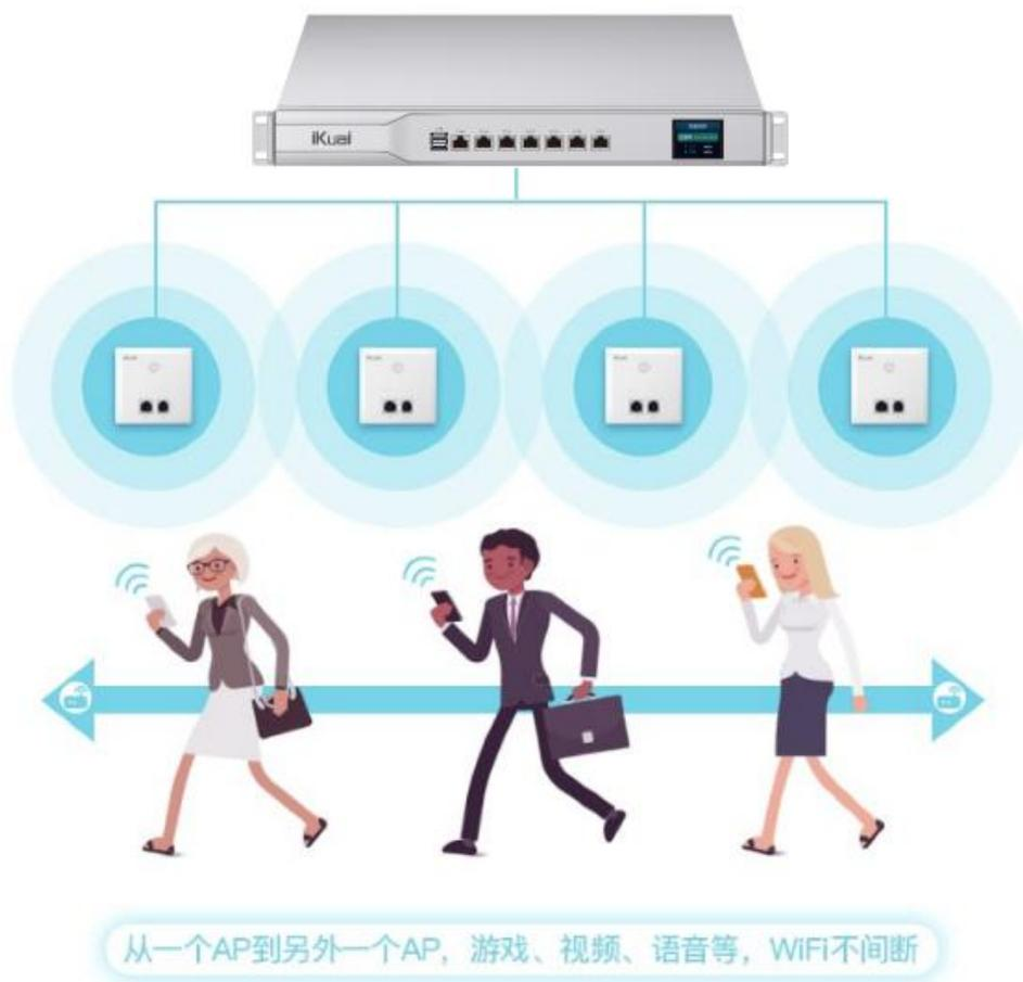
网关内置 AC 控制器, 支持爱快 AP 集中管理, AP 可视为虚拟天线无需任何配置步骤, 接入网络后自动读取无线配置, 零基础组网、随时扩容; 支持标准的无线漫游机制, 实现 AP 之间无缝漫游, 游戏、视频、语音等业务移动不间断。
